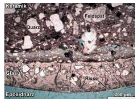
Abb. 61: Dünnschliff der glasierten Ofenkachel im Durchlicht. Die Probe musste zur Herstellung in Epoxidharz eingebettet werden.
