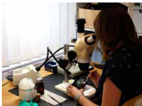
Abb. 60: Die Untersuchung und Freilegung der Oberflächen erfolgt überwiegend am Auflichtmikroskop. Komplexe Objekte werden hier auf ihre Bestandteile, einschließlich organischen Anhaftungen wie beispielsweise Holz und Textilien, analysiert.
